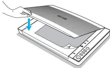
4. Если вы сканируете книги или другие толстые документы, вы можете поднять крышку сканера вверх или снять ее.
